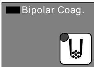
In dem rechten auf der Frontplatte blau gekennzeichneten Betriebsfeld "Bipolar Coag" wird durch eine Leuchte (8) die Aktivierung von bipolarem Koagulationsstrom angezeigt, es steht eine Stromart zum bipolaren Koagulieren zur Verfügung:
