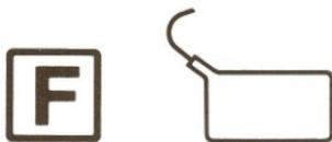
Anschluss für die Neutral-Elektrode. Neutralelektrode bei Hochfrequenz von Erde isoliert.
