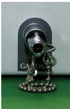
Abb. 3 Luer Adapter zum Anschluss von männlichen Luer-Ansätzen an die Buchse 2, Abb. 2
